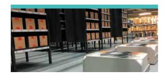
為迎合零售業的新轉變,嘉里物流把建基於雲架構的倉庫、 配送系統與機械人結合,以提升履行訂單的效率。其中對訂單 和銷售趨勢進行大數據分析,能自動並即時排出流動貨架的位 置,確保快速流轉的產品最貼近取貨站。
